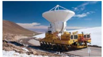
山頂施設に向けてトランスポーターで運ばれる、欧州製アンテナ1号機。カーボン素材を多用したことによる、つるつとした外観と直線的な副鏡支持機構が特徴です(クレジット: ALMA (ESO/NAOJ/NRAO), S. Stanghellini (ESO))。
