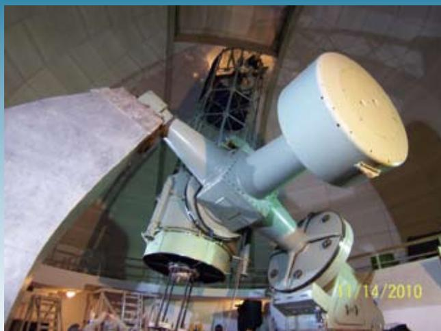
写真4:望遠鏡筒頂部に装着したドームフラット光源を点灯したコッタミア188cm望遠鏡。
