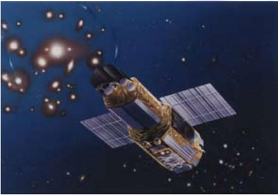
図1 2005年7月10日に打ち上がった「すざく」衛星(想像図)。前方に出ているのは全反射を利用してX線を集光するX線望遠鏡で、検出器は胴体底部分にある。
