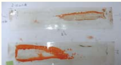
図1 歯当たり確認試験の結果。歯が当たっている部分が赤くなっている。片当たりしている状況がよく分かる。歯当たりが順方向回転（上）と逆方向回転（下）で左右にずれているのは、歯当たりが斜めになっていることを示す。
