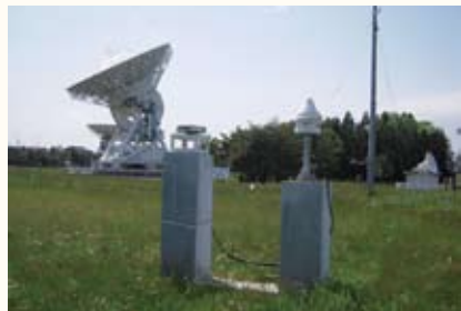
コンクリート製のピア向かって左側が GPS のアンテナ、右側が Galileo 衛星（EU の全地球航行衛星）の試験追跡局用のアンテナ。奥は、VERA 水沢局の 20m アンテナと 10m アンテナ。
