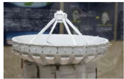
7m アンテナ模型のパラボラ部分。避雷針と鏡面裏のファンがリアル。
