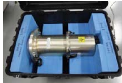
図2 輸送用コンテナ：黒色の輸送用コンテナの蓋を開けた状態。トランスポートチューブは防振のため青い緩衝材に固定する。コンテナは、最終的には輸送業者によりトライウォールと呼ばれる収容箱に緩衝材とともに梱包される。コンテナは、台内での落下テストをクリアした。
