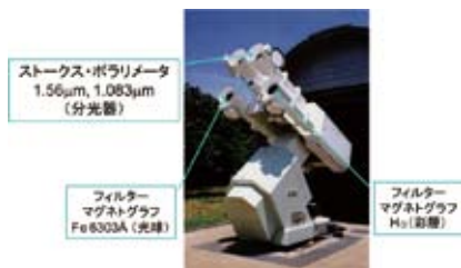
図7 2010年現在の観測装置配置
