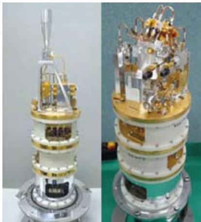
図1 日本担当のバンド4受信機カートリッジ (左)、バンド8受信機カートリッジ (右)。
