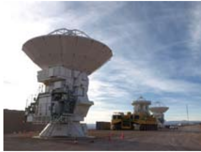
図1 ACA12mアンテナ（手前）と7mアンテナ（奥の台車上のアンテナ）。ACA12mアンテナとはほぼ同じ架台に小さな主鏡面が載っているの、一見するとロボットのような。現在1号機がチリ山麓施設にその姿を現して、現地で注目を集めている（山麓施設にて）。
