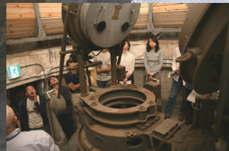
塔最上部ドーム内のシーロスタート。
