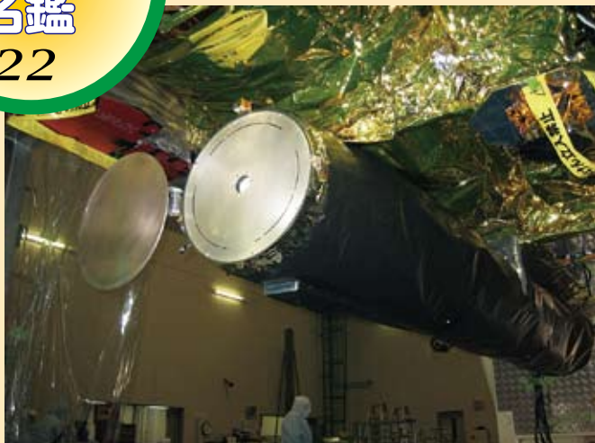
▲「ひので」衛星に取り付けられたXRT。サンシールド(銀色の円板部分)の周辺にある円弧状の隙間が、軟X線の開口。中央の孔の奥には可視光用の結像レンズが収められており、X線観測と同じCCDで位置あわせ用の可視光像がとれる。
