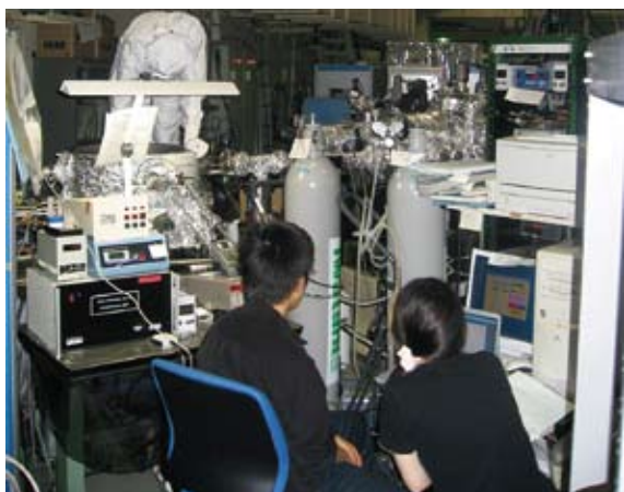
▲分子科学研究所（岡崎）でのMgF 2 結晶の屈折率測定実験のようす。
