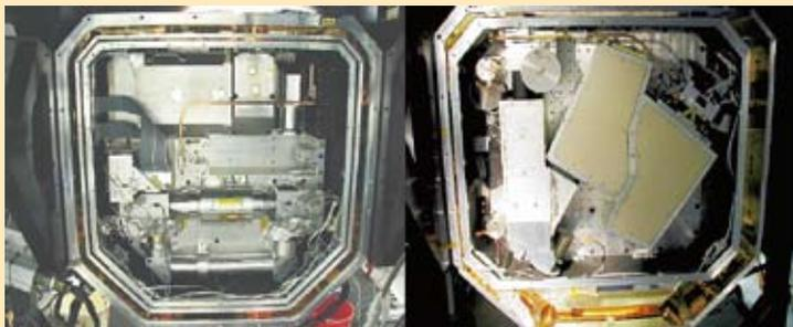
▲ IRCS の光学系内部。撮像及び低・中分散グリズム／プリズム分光を担う CAM (側左側)と、高分散エシェル分光を担う SPG (側右側)。CAM 側は、高分散エシェル分光時に、近赤外用スリットビューアとしても活用される。
