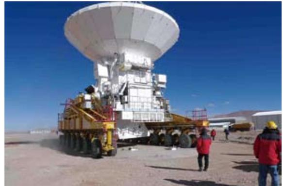
▲図3 山頂に到着。アンテナ基礎への最終アプローチ。オペレータ(中央)が、リモコンでトランスポーターの挙動をミリ単位の精度で操る。
