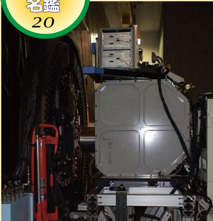
▲「すばる望遠鏡ナスミス焦点に取り付けられた IRCS。
