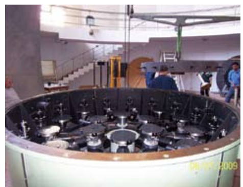
▲図3 188cm望遠鏡の主鏡と主鏡セル。
