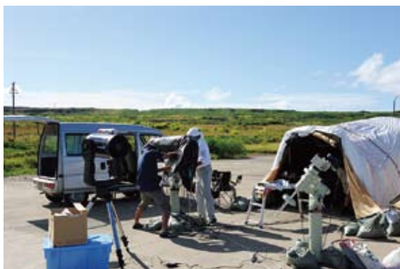
▲観測地の準備風景。2人が作業しているのは、分光望遠鏡に遮光・温度対策用の暗幕を巻いているところ。左側は白色光観測用の口径25cm望遠鏡。
