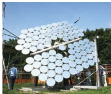
◀ヘリオスタット。直径50cmの反射鏡92枚できている。
