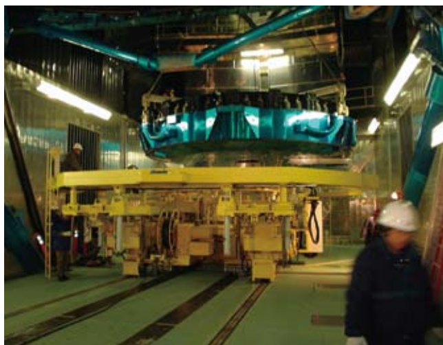
▲再蒸着作業風景：望遠鏡から鏡をとりはずす。
