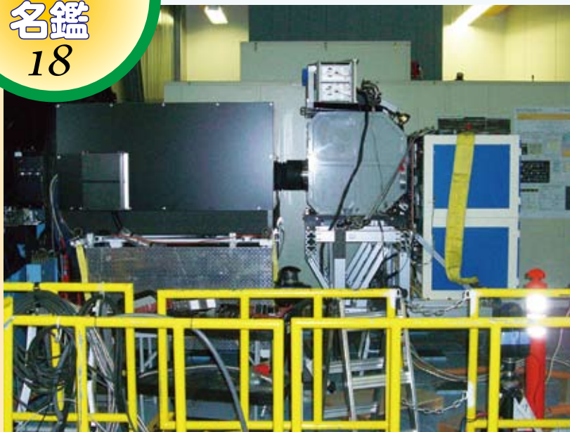
▲すばる望遠鏡ナスミス焦点に取り付けられた AO188 (左側)。主に近赤外線撮像分光装置 IRCS (右側) と共に用いられる。
