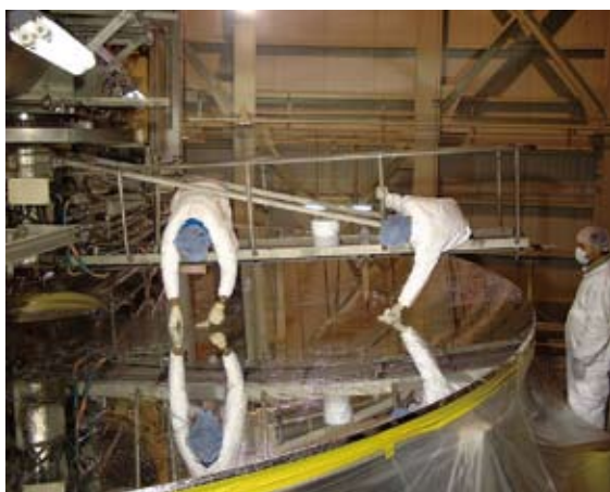
◀再蒸着作業風景：手で鏡を拭く作業もある。
