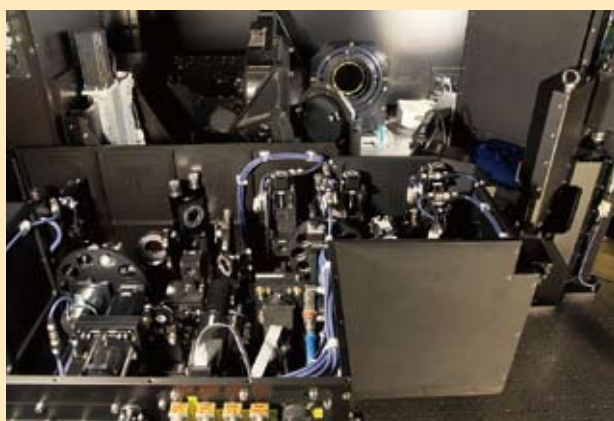
▲すばる望遠鏡ナスミス焦点に取り付けられた AO188 (左側)。主に近赤外線撮像分光装置 IRCS (右側) と共に用いられる。
