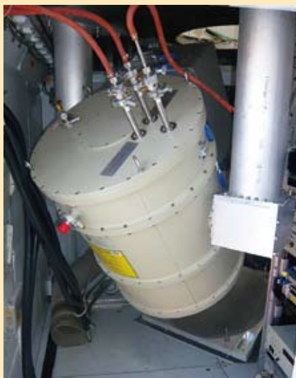
◀ ASTE 望遠鏡の受信機室内に設置された AzTEC カメラの冷却容器と光学系。
