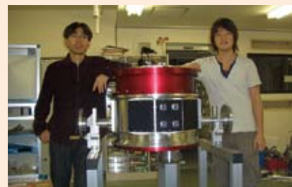
▲ 新しい TES カメラは、パルスチューブ型冷凍機を使用。これで、真冬の寒さに震えながら液体ヘリウムを 2 日に 1 回充填するという残酷物語から解放されます！
