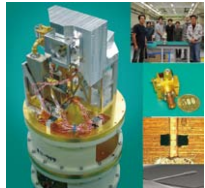
●表紙画像 先端技術センターの Band10 チーム(右上)が開発した ALMA 最高周波数受信機超伝導 SIS ミキサー。本体(左)とミキサーブロック(右中上)、ブロック内部光学顕微鏡写真(右中下)、NbTiN 薄膜を用いた超伝導集積回路の走査電子顕微鏡写真(右下)。
