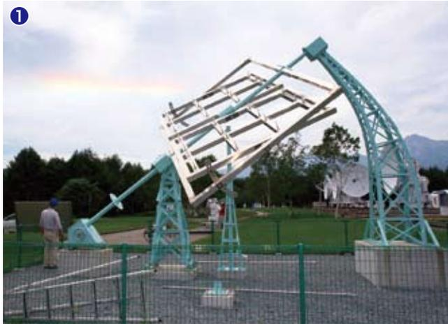
①展示では固定されている復元1号望遠鏡のアンテナ面を動かしてもらおう。復活取材に華を添えるように太陽スペクトルも祝福。②縦2.5m×横5mのアンテナ面にダイポールを8組並べて2軸で制御していた。アーチ鉄塔が特徴的だが、じつは、これ…⑦へ。③復元の立役者、森さんの証言を観測。
