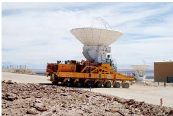
図1 移動台車にて輸送されるACAアンテナ。
