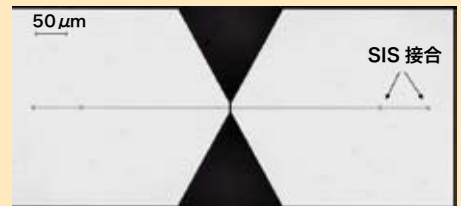
▲ SIS 素子顕微鏡写真。SIS 接合のサイズは約 2 \mu m。SIS 素子は先端技術センター内クリーンルームで制作されている。
