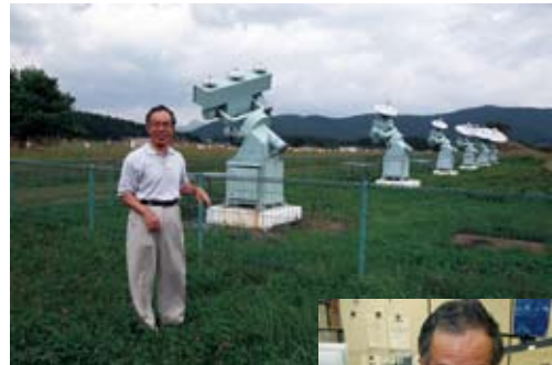
▲7つの波長別の太陽電波強度偏波計。「一番手前の80GHzはナル干渉計になっています」。
