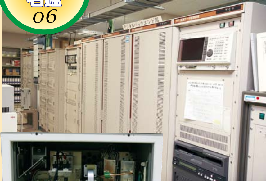
▲観測棟内に設置されたバックエンド受信機。フロントエンド受信機からの信号を光ファイバー（ラックの上の黄緑色のケーブル）で受け取り、A/D変換後相関処理する。
