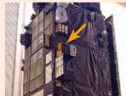
◀ 筑波宇宙センター (JAXA) で試験中の「かぐや」に取付けられた LALT-TR (写真中央・矢印)
