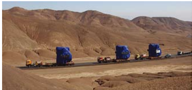
図2 チリの港からアルマ山麓施設(OSF)に輸送途中のアンテナ架台。
