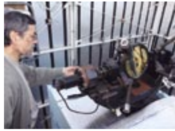
▲北望遠鏡の日周運動追尾鏡（サイデロスタット）。鏡面は金メッキだ。
