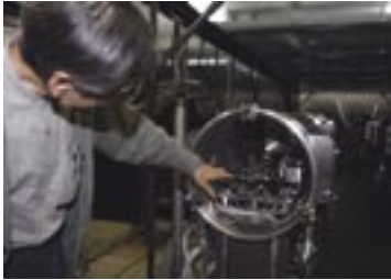
▲研究棟内の真空光遅延線槽の末端。パイプ内のレール上で光学素子を移動させ、遅延線を調整する。
