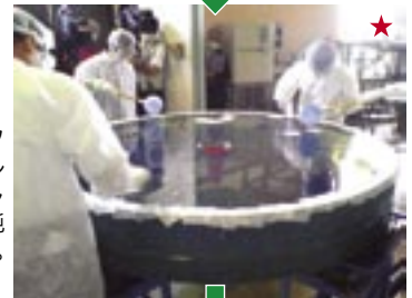
▲188cm反射鏡を専用台車に載せて移動。
