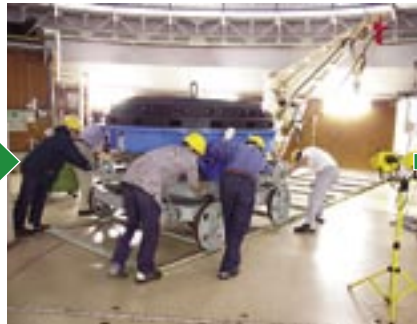
▲188cm反射鏡を専用台車に載せて移動。
