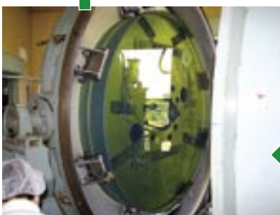
▲蒸着釜に入れて真空引き。1億分の1気圧になったらフィラメントに電気を流し、アルミニウムを溶かして蒸発させ、鏡面に「蒸着」させます。
