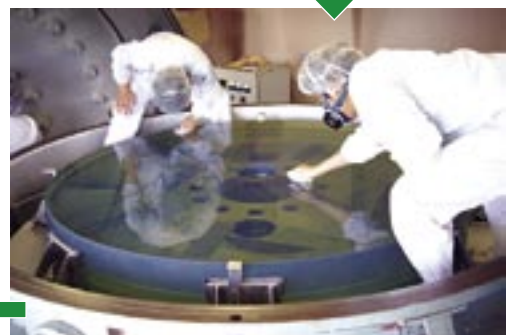
▲188cm反射鏡を蒸着釜に取り付け、アルコールエーテルを少量付けた綿布で鏡面を綺麗に拭き上げます。
