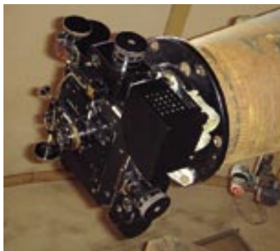
▲図3 撮影のために取り付けられた2代目のマイクロメーター接眼部。
