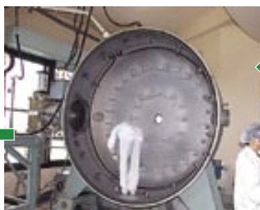
▲蒸着釜ではアルミニウムを溶かして付着させたフィラメントを電極に取り付けていきます。
