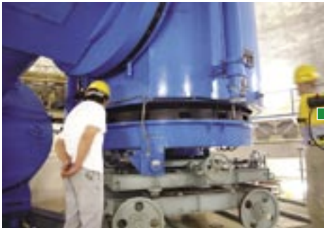
▲188cm反射望遠鏡から主鏡を取り外します。
