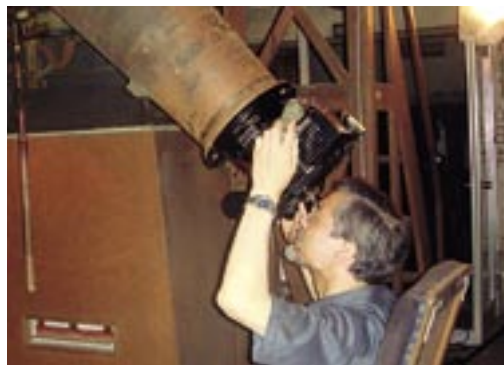
▲図4 マイクロメーター接眼部を覗きながら十字線で星を追尾する観測の様子。
