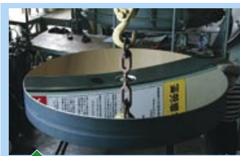
▲今年は宇宙科学研究本部の1.3m反射鏡、広島大学東広島天文台の1.5m反射鏡の蒸着作業も行いました。左は蒸着前の1.3m反射鏡、右は蒸着後の1.5m反射鏡です。輝きの違いがわかりますか？
