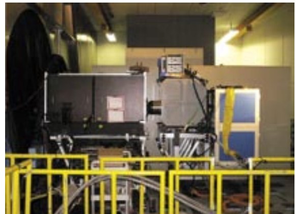
図2 ナスミス焦点に設置したAO(左、黒い箱)とナスミス用に改造した観測装置IRCS(右、灰色)。レーザー室(3m×5m)が背後にあります。
