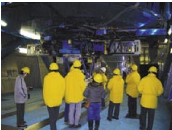
すばる望遠鏡を見学中。ここは望遠鏡の真下のカセグレン焦点。我々が観測に使う FOCAS が付いており、佐々木さんが解説中。
