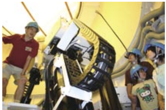
▲VERA石垣島観測局・20メートル電波望遠鏡の内部見学ツアーも大好評。観測所の本間希樹さんは、焦点面の受信機台に立って、世界初の2ビーム焦点装置のしくみを熱弁中。
