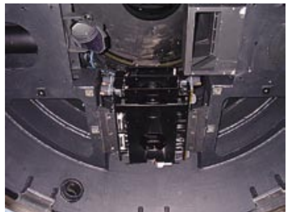
図1 すばる望遠鏡の赤外線コロナグラフ CIAO 用の偏光器の外観。スライド方式で波長板を光路に導入する。上段が 1/2 波長板、下段が 1/4 波長板の回転機構。カセグレン焦点の補償光学系の上方に取り付けられているため、装置固有偏光が小さい。偏光子は CIAO カメラ本体中に内蔵・冷却されている。
