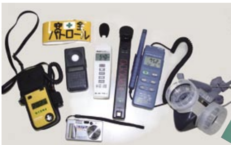
▲岩下さんが持ち歩く“環境測定七つ道具”。左から、酸素濃度、照度、騒音、粉塵、温度・湿度の各測定器。そしてガスマスクと、下はデジカメ。カッコイイ！
