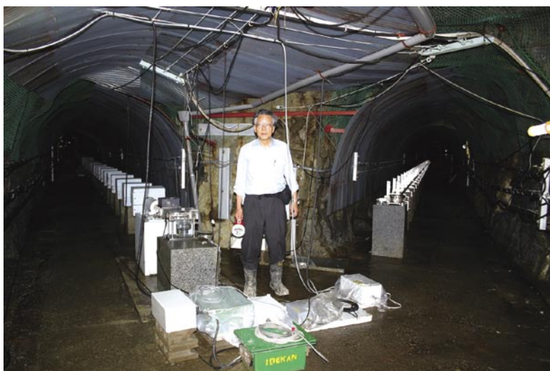
(左) 江刺地球潮汐観測施設の坑道内、通称「三角通路」入口付近。低膨張の石英管を20メートル以上もつないだ歪計など、地殻変動を測る計測器が多数設置されている。施設構内の重力測定室には、超伝導重力計（6月号参照）や絶対重力計の観測サイトがある。上の写真は国際絶対重力基準点網のベンチマーク。日本では、ここ江刺と筑波、京都および南極昭和基地の4か所が定められている。
