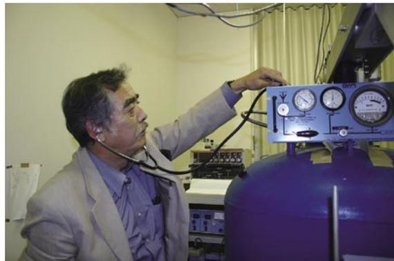
▲水沢観測所から約20km東にある江刺地球潮汐観測施設に設置された超伝導重力計(右の青いタンク)の点検をする佐藤さん。「医者が使う聴診器で内部の音を聞き、タンクの振動を点検します」。液体窒素で極低温に冷やされた検出器は、1000億分の1の重力変化を捉えることができる。
