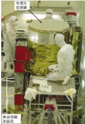
写真2 太陽光試験のため焦点面観測装置と結合された可視光望遠鏡
