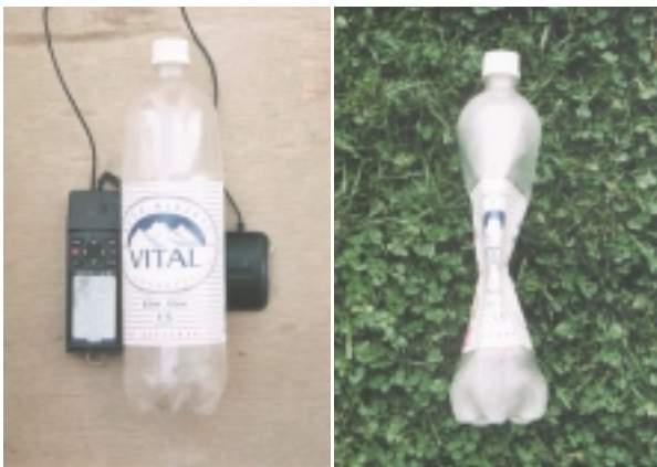
写真2：ALMA建設候補地から持ち帰ったペットボトル。左側が標高5000mでの元の姿で、右側がサンチャゴ(標高500m)での姿。
