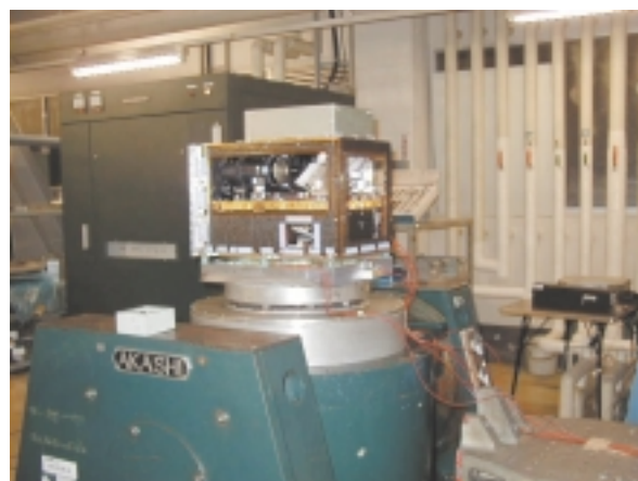
振動試験(Z軸)中のLALT-TR
