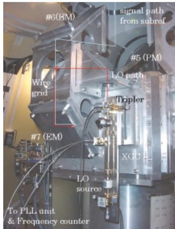
写真1：野辺山ミリ波干渉計のF号機に搭載された、350GHz帯受信機光学系及び局部信号発振器系。第5鏡の上から入射してくる信号は、第6鏡と第7鏡の途中にあるワイヤー・グリッド（太さ20 \mu\text{m} ・間隔80 \mu\text{m} 、タンゲステン）で局部発振信号（110GHz帯Gunn発振器+3通倍器）と準光学的に結合され、デューア内部にあるホーンへと伝送される。SISミキサー（parallel-connected twin junction; PCTJ）で4.5~7GHz帯のIF信号へと変換された後、光ファイバーで干渉計観測棟へ伝送され、A/D及び相關器系で信号処理される。
