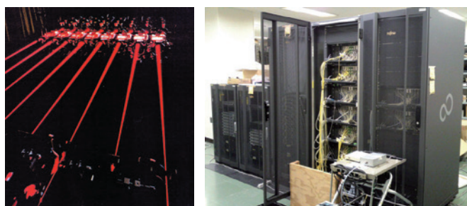
図10 左は、野辺山45m電波望遠鏡の大型音響光学型電波分光計「AOS」。チャンネル数3万2000、最大帯域巾2GHz。観測開始以来30年間、世界最大の電波分光計としてさまざまな発見をもたらした。右は現在使われている新型分光計SAM45。
