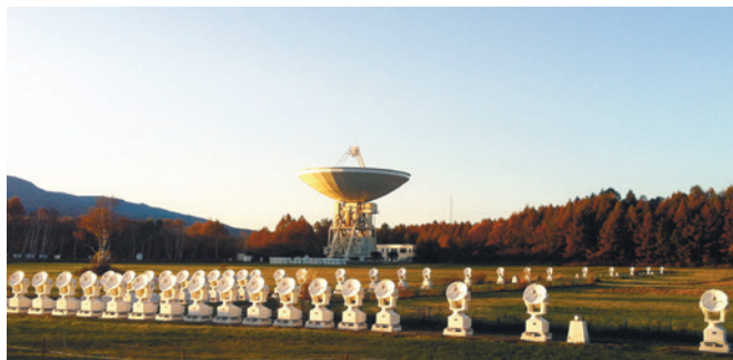
図10 野辺山太陽電波観測所の電波ヘリオグラフ。奥の大きなパラボラは宇宙電波観測所の45 m電波望遠鏡。
