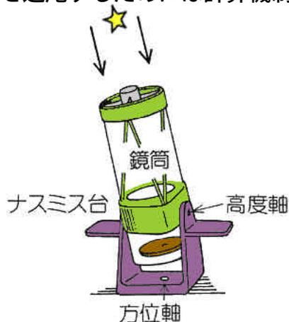
また、長時間露光する場合には写野が回転してしまうので、視野回転装置が必要になります。
