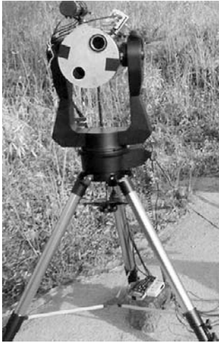
図 12. 実際に測定に使用しているDIMM.
