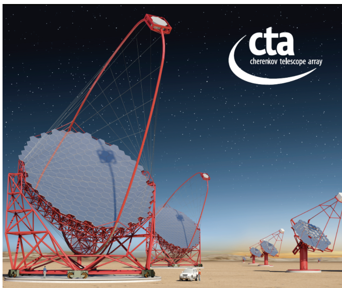
図 4.4 左図：CTA 国際宇宙ガンマ線天文台のイメージ。手前に見えるのが、23m 大口径望遠鏡。右図：CTA の設計感度曲線。従来の装置と比べ桁高い感度と、20GeV から 100TeV のエネルギー領域をカバーする。
