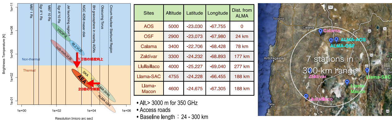
図 2.1 左:干渉計の分解能（横軸）と輝度温度感度（縦軸）。AEA は VLBI に比べて 1 万倍の輝度温度感度向上、ALMA に比べて 20 倍の分解能向上をもたらす、熱的放射を最高分解能で観測する。右:AEA のアレイ配列案。AOS, OSF は ALMA の山頂サイトと山麓施設, LLAMA 計画の 2 局も記してある。
