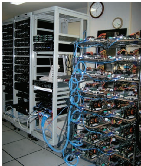
図1. 天の川クラスター全景. 左の19インチラック二本と右のアルミラック上に合わせて32ノード, 24台のGRAPE-7が設置されている. 真ん中の19インチラックにファイルサーバ, ネットワークスイッチ等が設置されている.
