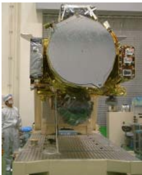
図1. フライトモデルが実装された Solar-B 衛星望遠鏡開口部。中央部が可視光望遠鏡で左側の灰色のものがその焦点面装置。X線望遠鏡(下)と極紫外線撮像分光装置(上)は汚染防止のため黒いカバーで覆われている。
