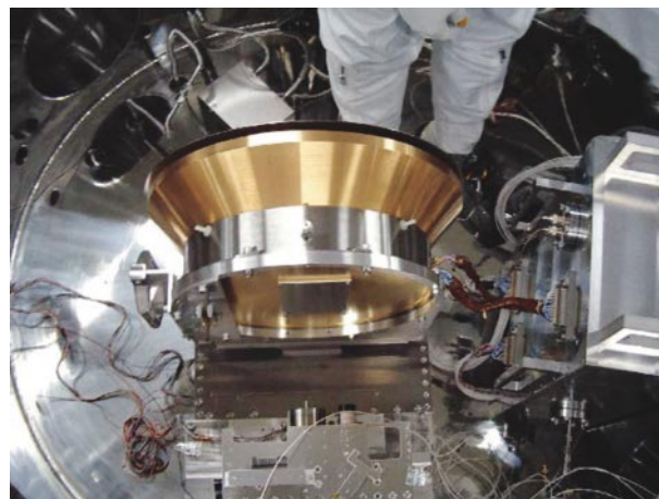
図2. X線量子効率測定のため開発実験センター・中型真空槽内に設置された CCD カメラ。
