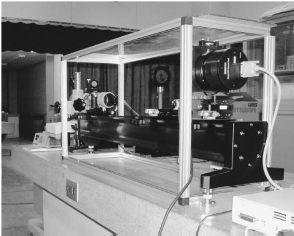
図 1. Centroid 実験装置全景。光学ベンチ上には、奥から擬似星光源、集光レンズ、手前に CCD カメラがある。CCD カメラは、ステッピングモータをパソコン制御することで、高精度な位置制御が可能である。
